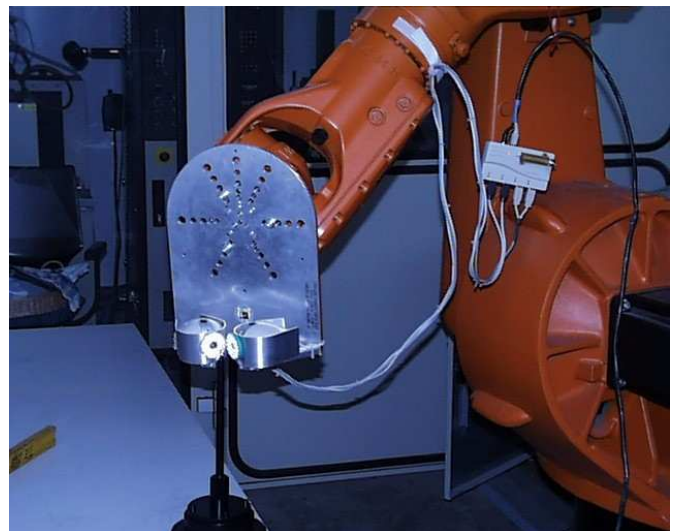
Abb. 6: Vermessung eines Knickarmroboters mit ROSY
