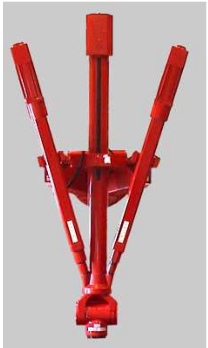
Abb. 4: Tricept TR600 der Firma Neos Robotics [7]
